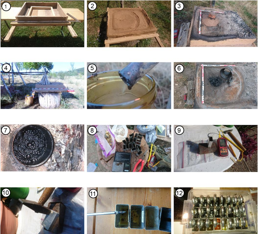
**Abb. 2: Durchführung des Experiments. 1-2 Holzverschalung und Ofenkonstruktion, 3-6 Betrieb der Ofenkonstruktion, 7 Verdicken des hergestellten Pechs, 8 Erstellung von unterschiedlichen Mischverhältnissen, 9-12 Überprüfung und Analyse der Proben. – Conducting the experiment. 1-2 wood cladding and furnace construction, 3-6 operation of the furnace construction, 7 thickening of the produced pitch, 8 creation of different mixing ratios, 9-12 review and analysis of the samples.**
